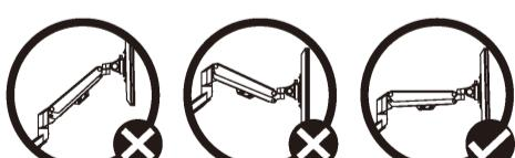
**! UPOZORNĚNÍ:** Aby nedošlo k poškození monitoru nebo držáků, vždy držte rameno při nastavování ve vodorovné poloze.
