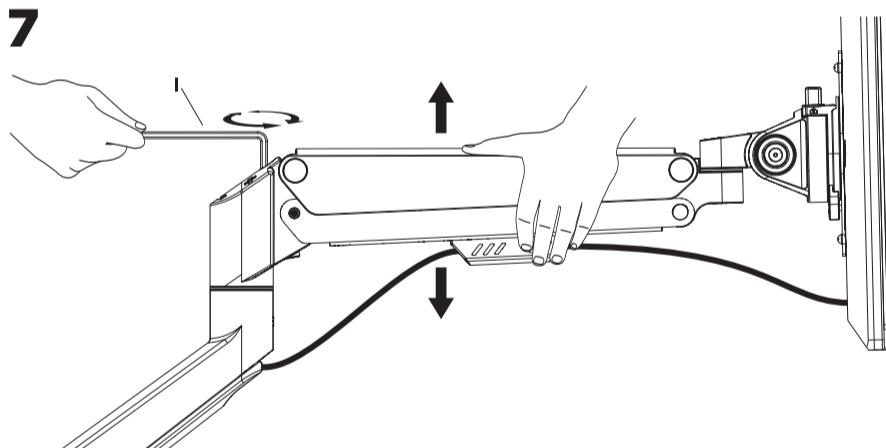
Pro správné vyvážení ramene s namontovaným monitorem nastavte napětí pružiny pomocí dodaného imbusového klíče následovně:
